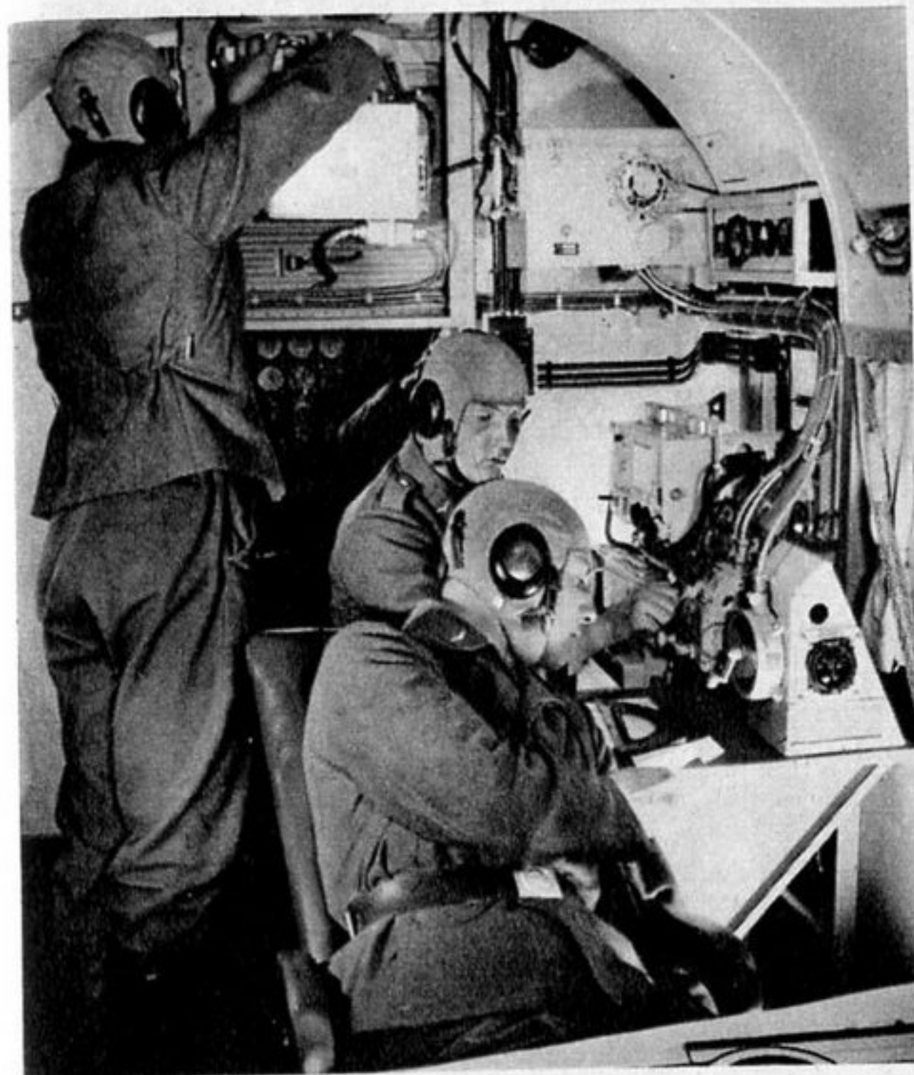
Schulung im Blindflug an einem Modell, das durch den Deckel völlig geschlossen werden kann und mit allen Instrumenten für den Blindflug ausgerüstet ist
