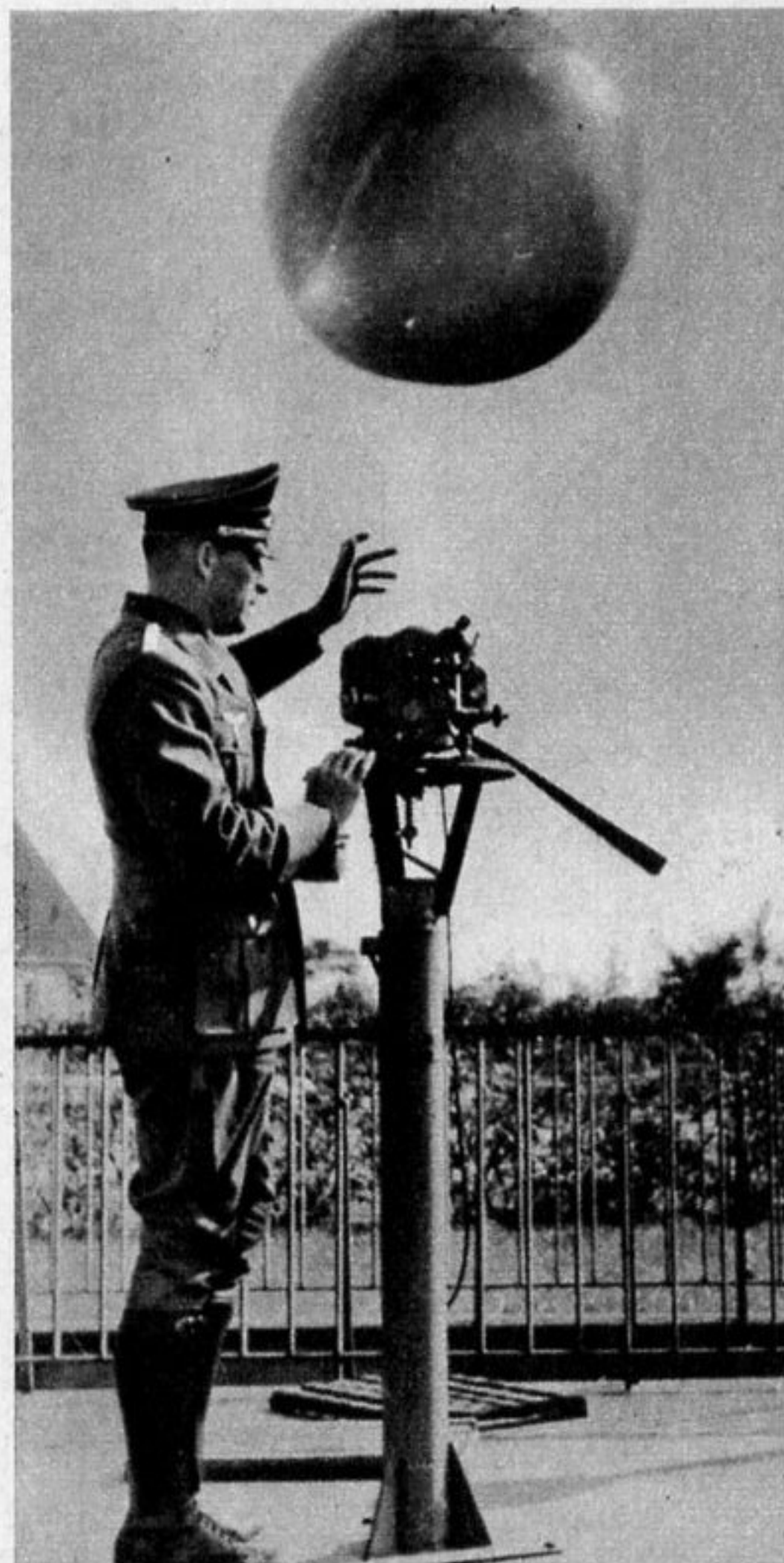
Die Wetterdienststelle bei der Arbeit. Mit Hilfe des Ballons werden Windstärke und Windrichtung gemessen
